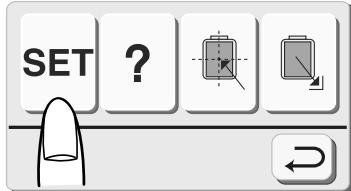
Pressionar a tecla de **AJUSTE** abrirá a caixa de diálogo de ajustes da máquina.
